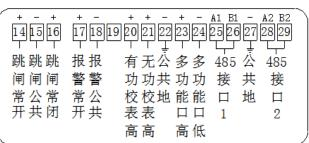
图 3 电能表接线端子功能示图
